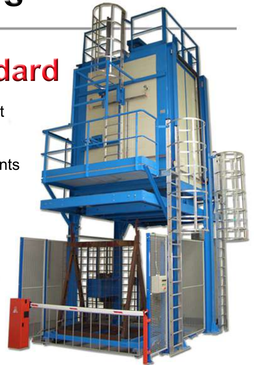
Four de trempé à chargement vertical
